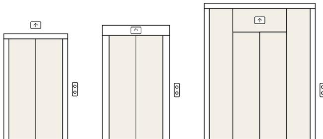
KES 602 und 800 mit 50 mm Rahmenbreite umlaufend
