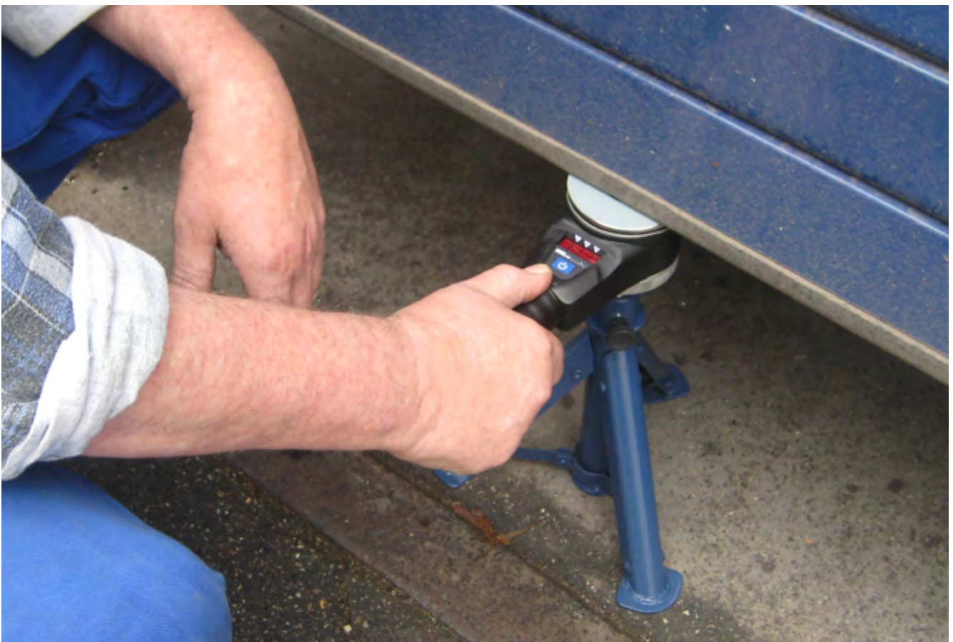
Abb. 25 Schließkraftmessung an der Hauptschließkante eines Torflügels
