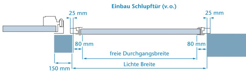
Nebentüren sind nicht mit einer Schwelle versehen. Die empfohlene Mindesthöhe beträgt 2.000 mm. Die empfohlene Breite beträgt 1.000 mm bis 1.250 mm
