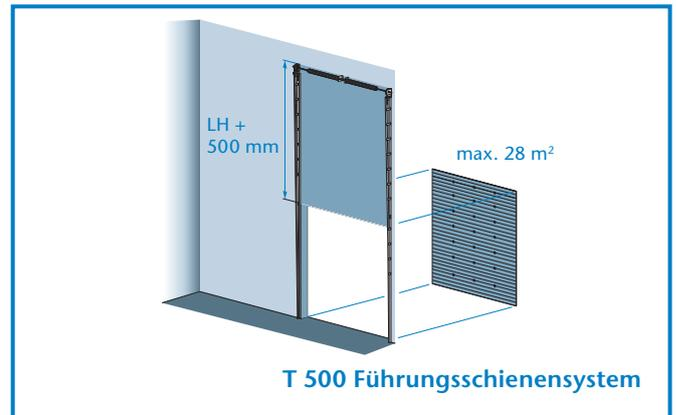
Dieses System kann verbaut werden, wenn der verfügbare Kopfraum ein vertikales Öffnen des Sektionaltors ermöglicht. Das Federpaket wird an der Wand oberhalb der Oberkanten der Führungen montiert.
