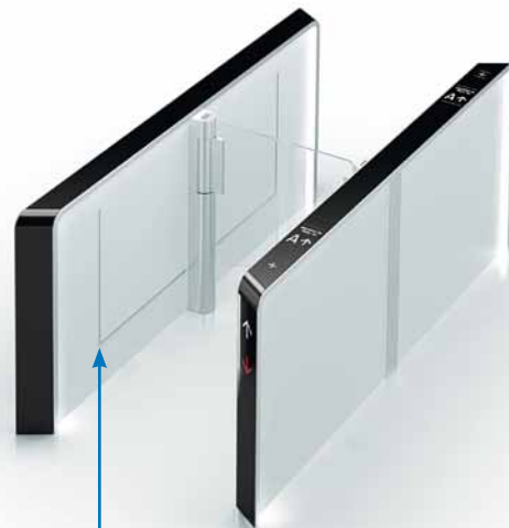
Diskrete Nutzersicherheit: In den halbhohen Schleusenwänden sind Sensoren eingebaut, die die Position der Passanten und eventuell mitgeführter Gegenstände, wie z. B. Trolleys erkennen.
